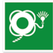
Rettungsring mit schwimmfähiger Leine und Leuchtapparat
