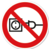
Am Kabel ziehen ist verboten
