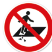
Betreten verboten, Durchsturzgefahr
