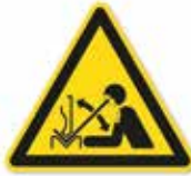
Warnung vor hoch-schnellendem Werkstueck in einer Presse W032
