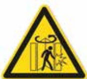
Warnung vor Verletzungsgefahr an der Drehtür
