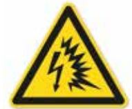
Warnung vor Lichtbogen W042
