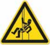
Warnung vor Höhenarbeiten am Seil Industriekletterer
