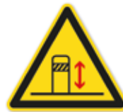
Warnung vor automatischer Polleranlage
