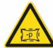
Warnung vor Unterdruck Raum - Zone
